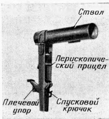
Рис. 1. Французское 68-мм реактивное противотанковое ружье «Арпак».
